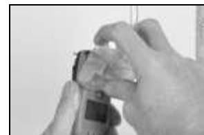
Per rimuovere la calotta di calibrazione, sollevarla per le linguette. Metterla da parte o riporla.
